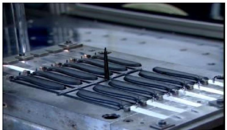
**IMPORTANTE:** Este proceso de inyección es una clara ventaja competitiva de los productos **ARCOS** debido a que el resto de fabricantes compran mangos de plástico con una ranura y los ensamblan después a la espiga del cuchillo mediante adhesivo y calor, perdiendo robustez, sujeción, huecos libres, etc...
